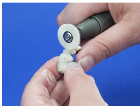
Für diesen Anwendungsbereich können wir auch unsere spezielle **Schwabbel für die Vorpolitur** bzw. eine **Nesselschwabbel** oder **Schmalbürste mit Nesselstoff** unter Verwendung von feuchtem Bims empfehlen.
